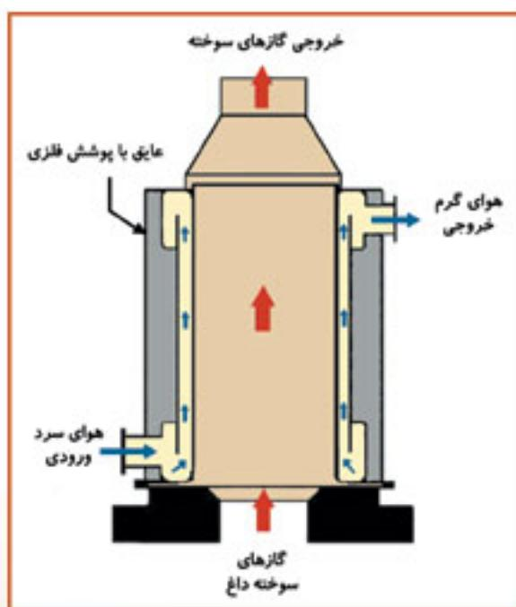
در رکوپراتورهای جابجایی، گازهای سوخته و داغ از میان تعداد زیادی لوله با قطر کوچک که درون یک پوسته بزرگ قرار گرفته‌اند می‌گذرد. هوای سرد نیز درون پوسته و بر روی لوله‌ها جریان می‌یابد. بدین ترتیب مقدار بیشتری از حرارت گازهای سوخته بازیابی می‌شود. راندمان این رکوپراتورها بین ۵۰ تا ۶۰ درصد است. در شکل صفحه بعد نیز یک نمونه از این رکوپراتورها بصورت شماتیک نشان داده شده است.
