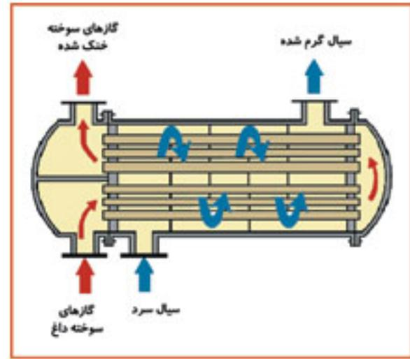
اکونومایزرها مبدل‌های حرارتی هستند که در آنها هوا و آب با هم تبادل حرارت می‌کنند. کاربرد اصلی این تجهیزات برای پیشگرم کردن آب تغذیه بویلرهاست، البته
