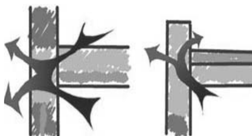
شکل ۸: پل‌های اتصال نادرست حرارتی
