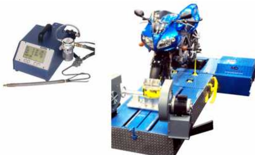
دینامومتر و آنالایز مورد نیاز برای اندازه گیری آلایندہ های خروجی از اگزوز موتورسیکلت در حالت بار ثابت
