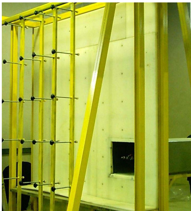
شکل ۲- نمایی از دیواره آرتلونی آزمایش و دریچه نصب شده روی آن
