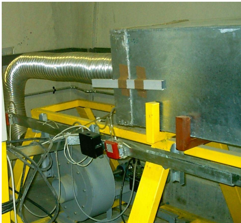
شکل ۵ - کانال هوا و لوله رابط
