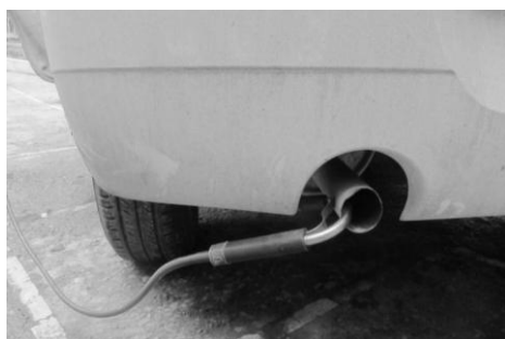
شکل ۱-۳ خودرو تجهیز شده برای آزمون همراه
