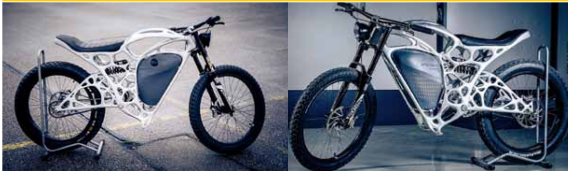
شکل ۷- تصاویر موتورسیکلت برقی Light Rider (V=80km/h و P=8hp)
